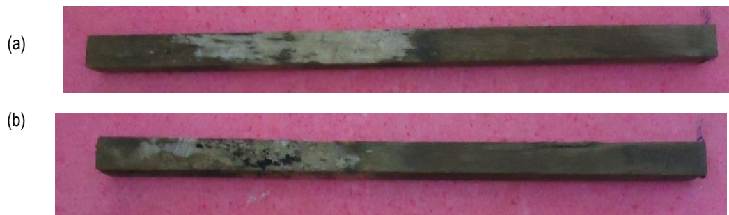
Gambar 6 Kayu kecapi (a) dan kayu rambutan (b) yang terserang jamur.
