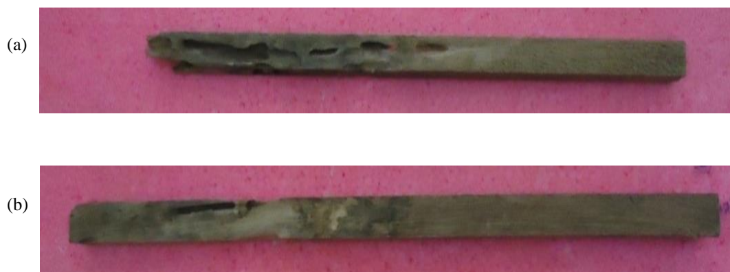
Gambar 3 Kayu kecapi (a) dan kayu rambutan (b) yang terserang oleh rayap.
