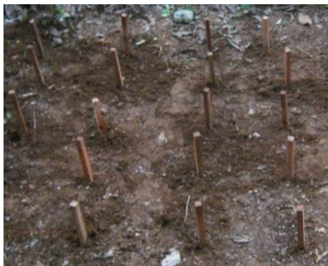
Gambar 1 Uji lapang keawetan kayu kecapi dan rambutan.
